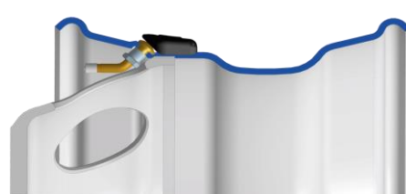
DCW-G3 – новое поколение Колесо с наружным вентиляем без хампа
