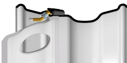
DCW-G2 – старое поколение Колесо с наружным вентиляем с хампом
